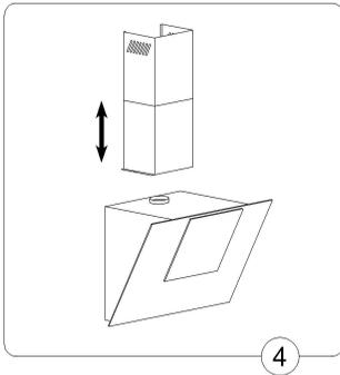
Der Teleskopschacht der Dunstabzugshaube besteht aus 2 ineinander gesteckten U-Profilen welche sich in der Gesamthöhe verstellen lassen.
